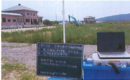
写真1 無線計測システムによる振動計
