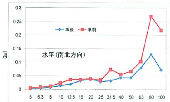
加速度波形のフーリエスペクトルの1/3オクターブバンド表示
