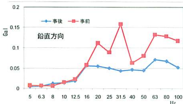
WIB工の施工前後の振動の比較
