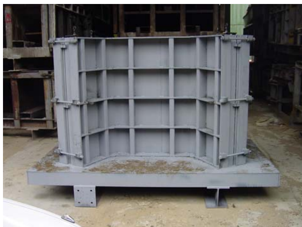
図-2 WIBセル用鋼製型枠
