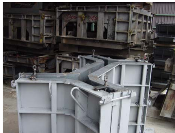
図-2 WIBセル用鋼製型枠
