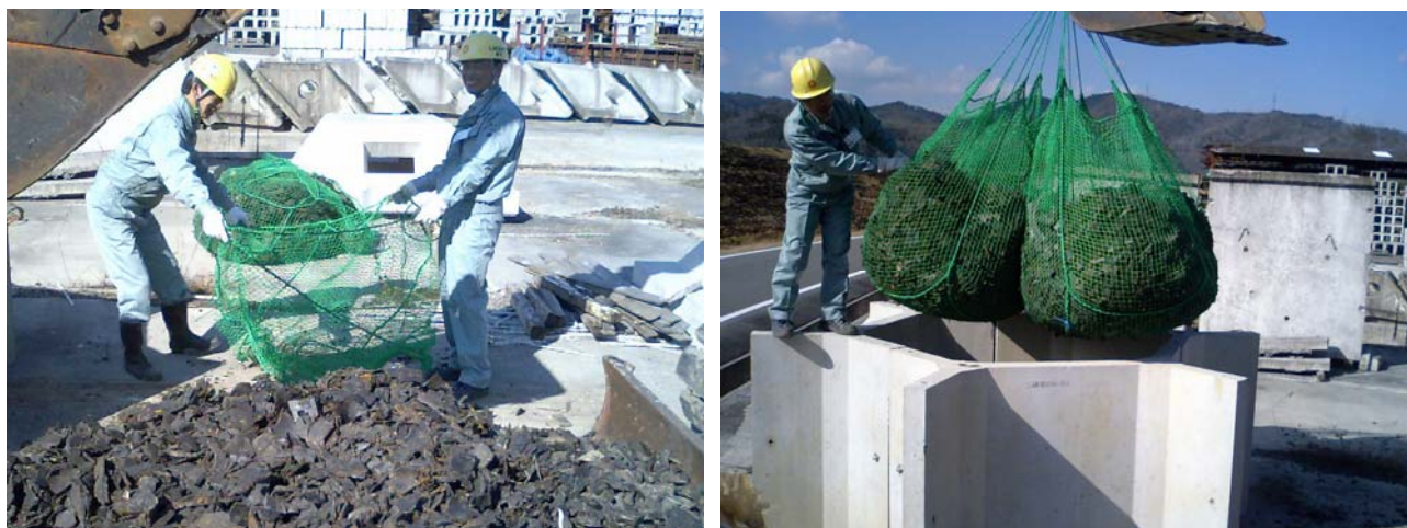
図ー5 廃タイヤシュレッド投入試験状況
