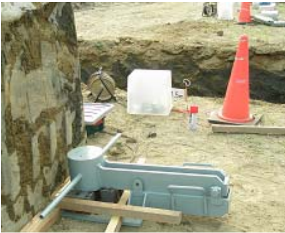
ガイドハンマーによる鉛直加振状況
