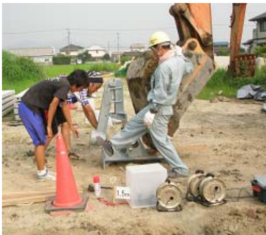
水平加振状況（面内方向）
