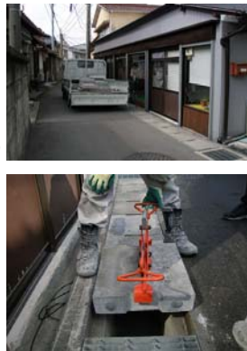
騒音発生を抑えた側溝蓋の開発 (実験ケースはゴム支承のデザイン/レイアウトの差)
